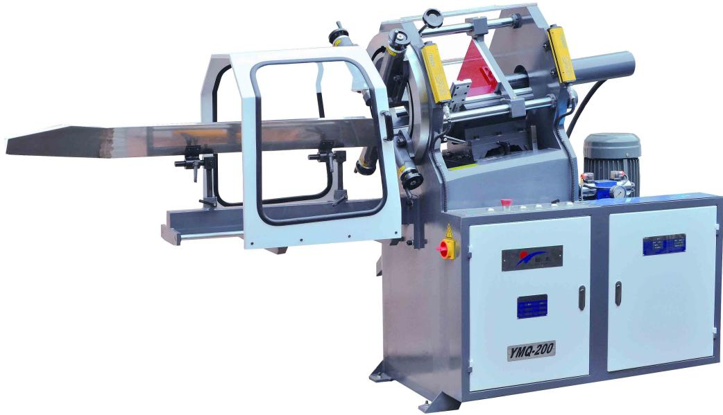
SWY-定制型索挖月机主要适用于各大生产笔记本、工作手册的纸品厂，是高级笔记本、工作手册等具有检索功能的特殊形状角挖切的必需设备。SWY-定制型索引挖月机设计合理、操作方便性能稳定，能提高产品档次，还可根据各种纸品的冲切需要，换用各种形状和规格的。
